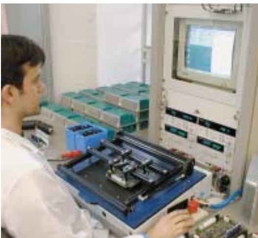
Bild 1: Prüfstand zur vollautomatischen Funktionsprüfung von Baugruppen mit Nagelbettadapter
